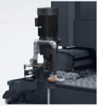
Instalación del depósito de lubricante arriba
