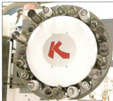
Cambiador automático de herramientas tipo random con brazo de doble pinza y almacén con 20 posiciones 20-station arm type automatic toolchanger.
