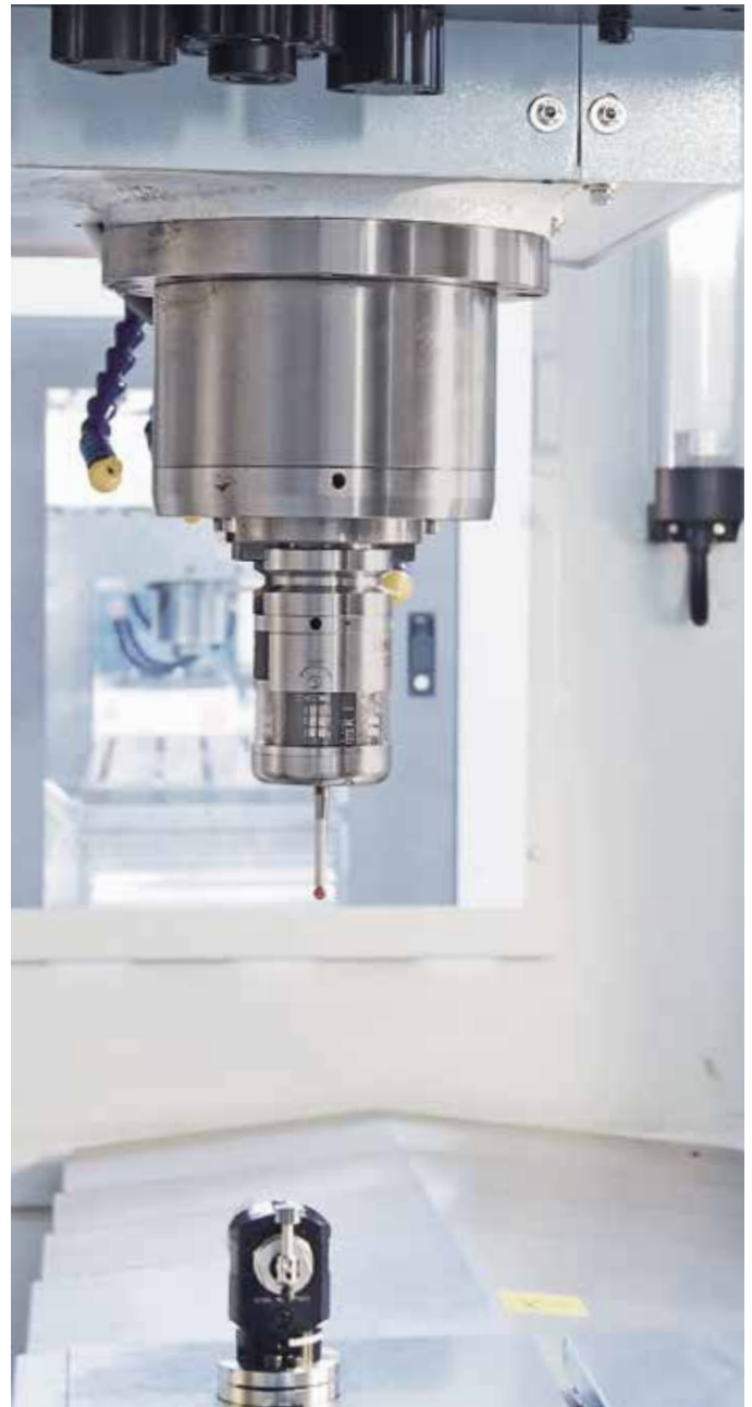
Sonda calibración de herramienta Tool setter Messtaster für Werkzeugskalibrierung Palpeur de mesure d'outils
